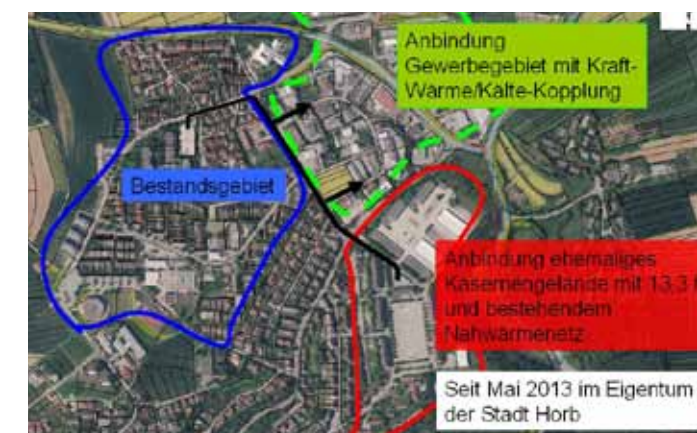
Abbildung 43: Erweiterung des Wärmenetzes Hohenberg
