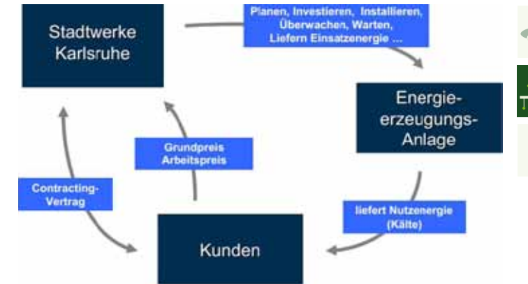
Abbildung 48: Kältelieferung im Contracting
