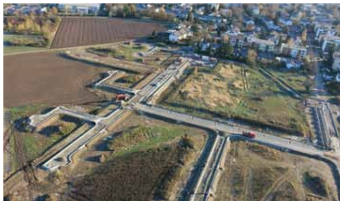
Abbildung 71: Erschließung und Nahwärmenetz, Stand Dez. 2013
