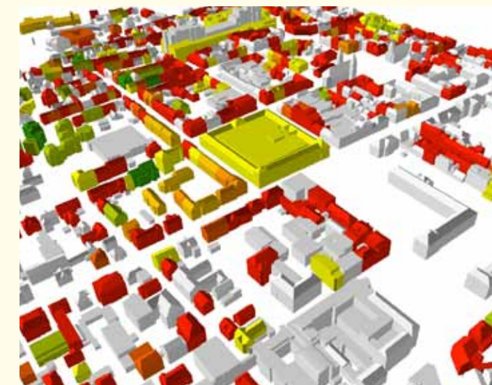
Abbildung 12: Datenerfassung über ein 3D-Stadtmodell mit Berechnung des Wärmebedarfs
