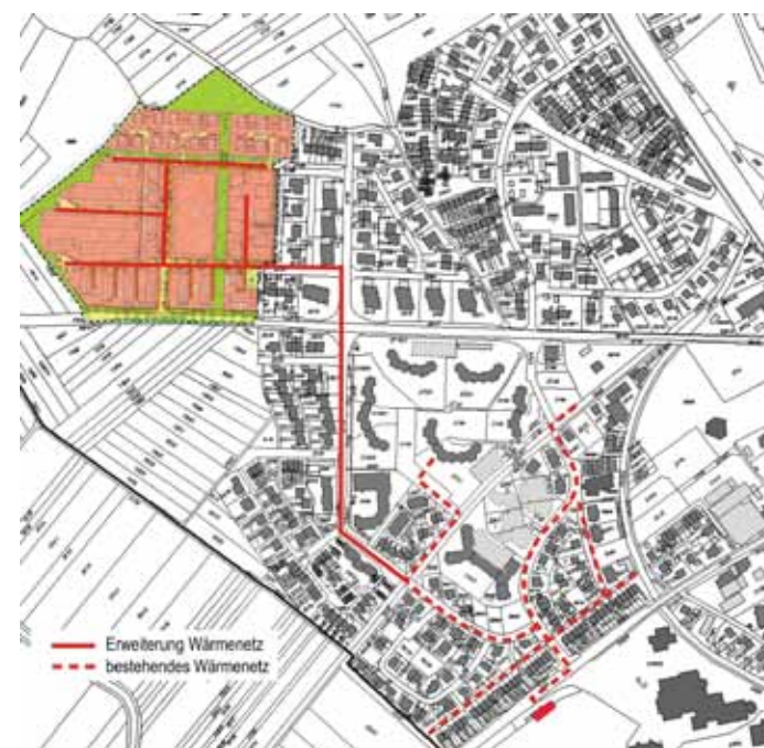
Abbildung 72: Neubaugebiet mit bestehendem und geplantem Wärmenetz
